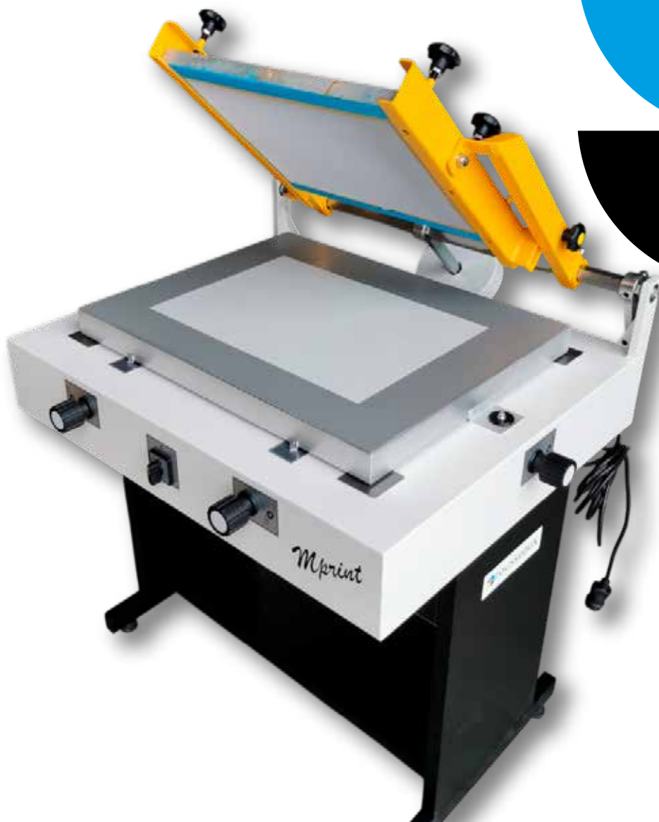
Contrepoids avec réglage de position pour l'équilibre du cadre
