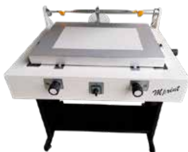
Réglage micrométrique de la table d'impression
