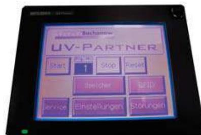
Nouvellement conçu, tous les tunnels UV-Star<sup>2</sup> sont équipés d'un écran tactile de contrôle. Les plus récents développements électroniques permettent la programmation de tous les paramètres et leur stockage dans 20 mémoires différentes (programmes).
