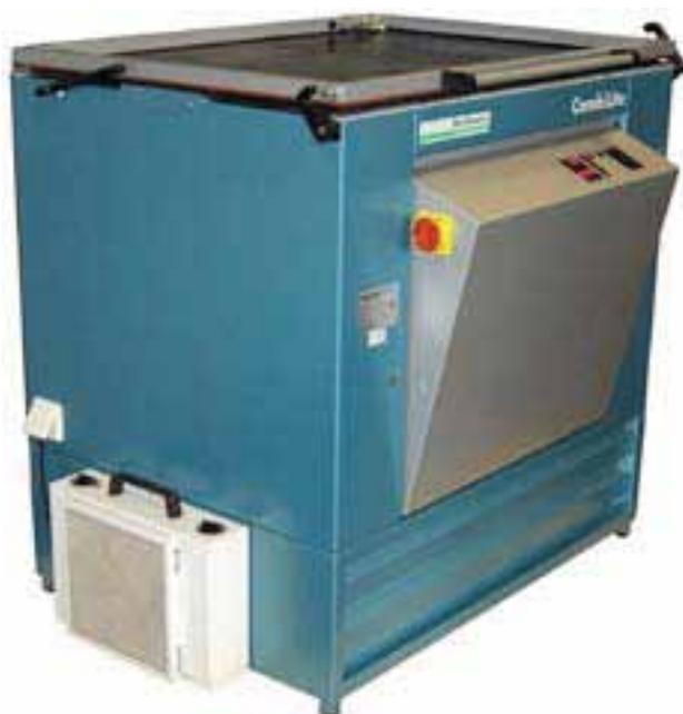
Combiné d'insolation UV avec en option une armoire de séchage pour écrans de sérigraphie <sup>1)</sup>.
