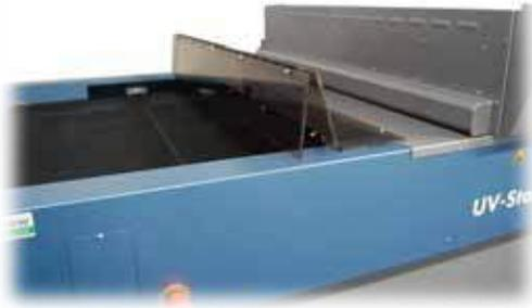
Le corps de la machine est réalisé en tôle d'acier peinte, avec une conception exempt de torsion. Des protections anti-UV sont livrées selon la largeur du tapis.
